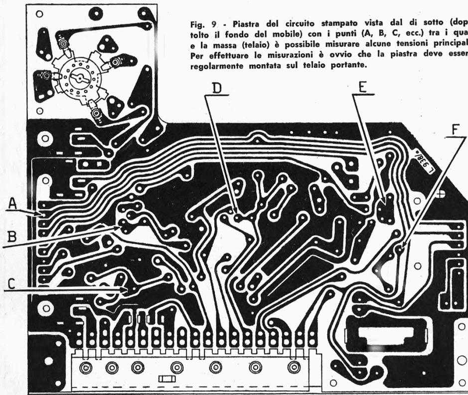
Fig. 9 - Piastra del circuito stampato vista dal di sotto (dopo tolto il fondo del mobile) con i punti (A, B, C, ecc.) tra i quali e la massa (telaio) è possibile misurare alcune tensioni principali. Per effettuare le misurazioni è ovvio che la piastra deve essere regolarmente montata sul telaio portante.
