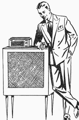
L'uso di un altoparlante esterno di grande diametro montato in adeguato mobile diffusore (ad es. il N. 3099, pag. 31) può migliorare notevolmente la qualità della riproduzione.
