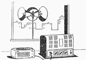
Per ottenere una maggiore potenza di diffusione il G 257 può essere collegato ad un amplificatore esterno mediante un cavo speciale n. 366.
