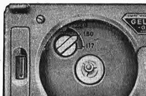
Il cambio tensioni è situato sotto la bobina sinistra. Sfilare la spina e reinserirla in corrispondenza della tensione disponibile.
