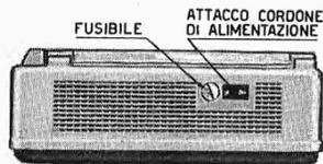
Se il fusibile si interrompe, sostituirlo sempre con un altro di uguale valore (0,3 A).
