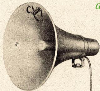
Due trombe Mod. 2571: può essere loro avviata una potenza di 12 W. (punta) per ognuna. Collegamento in parallelo - impedenza 10 ohm.
