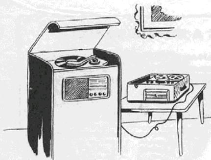
La registrazione può essere eseguita anche con l'impiego del solo giradischi. In tal caso, allacciato il motore ad una presa di corrente, si porterà il cavetto proveniente dal braccio fonografico all'entrata del magnetofono, sempre munendo il cavetto stesso dell'attacco raccordo N. 367. Lo stesso procedimento naturalmente può essere seguito anche per il caso del radiofono citato sopra, ove sia possibile accedere al cavetto del riproduttore. Col G-252 si adotti la velocità più elevata.
