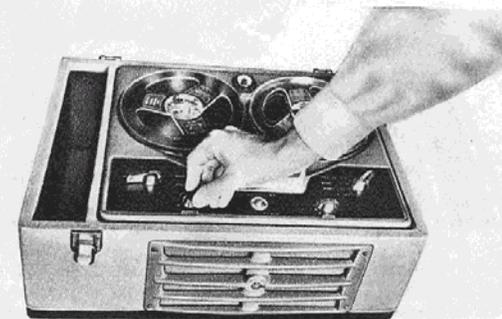
La registrazione, iniziata come si è detto, può continuare per tutta la durata di svolgimento della bobina e tale durata dipende dalla velocità di scorrimento del nastro che è caratteristica del tipo di magnetofono adottato (col G-252 si ha la scelta tra due velocità).
