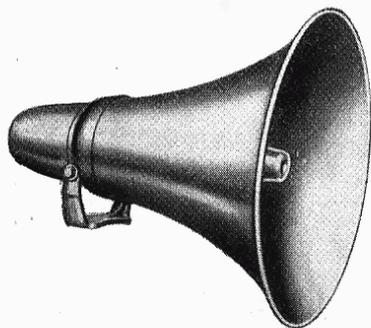
Questa tromba di notevole potenza è indicata per la sonorizzazione di un'ampia area all'aperto. In essa possono venire installate tanto la nuova unità magnetodinamica N. 2521 (impedenza 16 ohm) di elevata fedeltà di risposta, quanto le versioni di essa con trasformatore incorporato per medie od alte impedenze d'entrata (Unità N. 2522, da 16 a 1.000 ohm; unità N. 2523, da 16 a 5.000 ohm).
